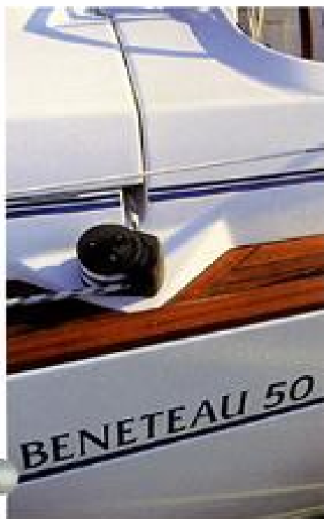
Route de retour de génie avec passage d'écoute intégré Genoa lining (deck) with recessed sheet lead
